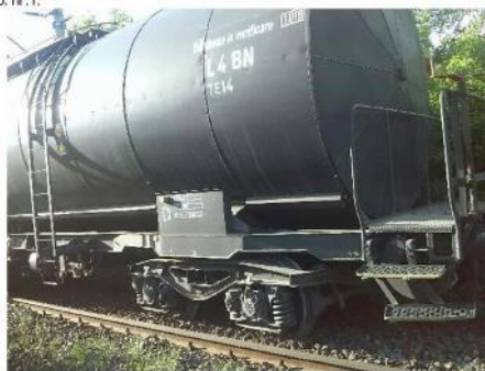
Foto. nr.1 – vagonul nr. nr.31537887008-5 deraiat de al doilea boghiu
