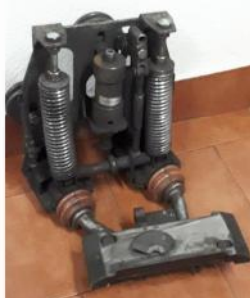
Figura 3. (sus) Captatorul avariat la REM 109, post efectuat în stația Gara de Nord 2 înainte de demontarea acestuia
