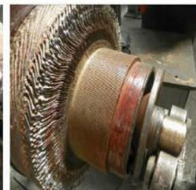
Fig.9 Colector fără urme de flămăre MET nr.4
